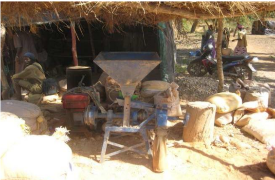
Conditions inappropriées de broyage de matériaux : source d'émission de poussières
