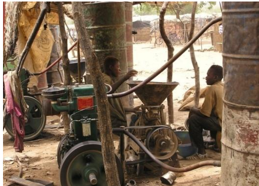
Conditions inappropriées de broyage de matériaux : source d'émission de poussières
