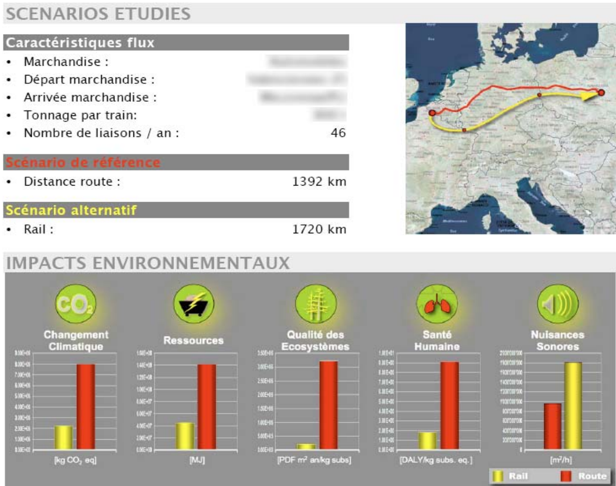
Figure 4 : Exemple de résultats obtenus à l'aide de la méthode Estia-VIA sur une ligne de flux entre le Nord de la France et la Pologne.
